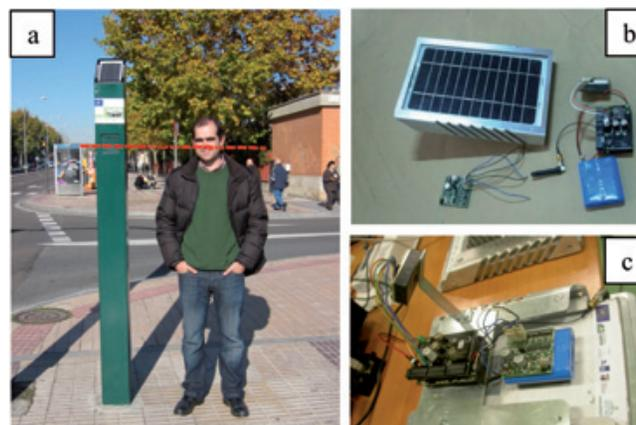
Fig. 3: Componentes del sistema de medición: a) poste, b) sistema de alimentación fotovoltaico, c) equipos de medida
