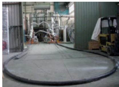
Figura 5: Instalación de un cable HTS en el centro de ensayos de cortocircuito y dieléctricos de TECNALIA. Izquierda: Modelo de cable funcional de 30 m. Derecha: Detalle de las terminaciones del cable y conexiones para los ensayos dieléctricos.
