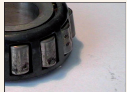
Figura 5. Detalle de efecto del golpeteo en rodamiento
