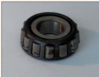
Figura 1. Deterioro en rodamiento
