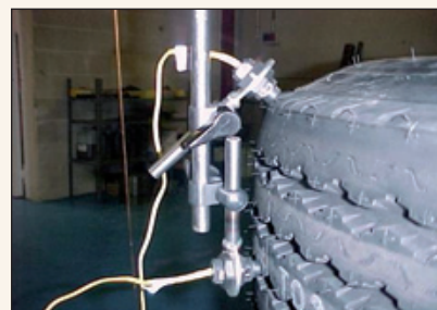
Fig. 3.- Detalle del montaje de dos sensores de infrarrojos próximos al neumático.
