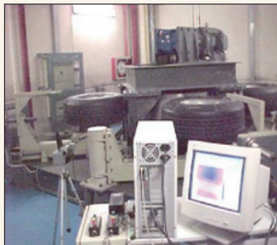
Fig. 2.- Montaje del dispositivo de captación termográfica en el banco de ensayos de neumáticos.
