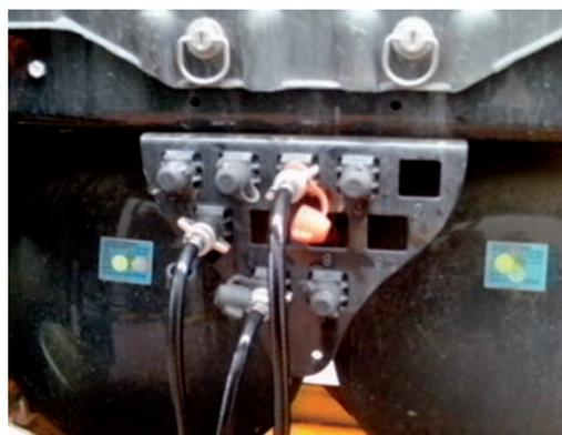
Figura 15: Camión (tomas de presión centralizadas e identificadas)
