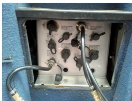
Figura 16: Autobús (tomas de presión centralizadas e identificadas)
