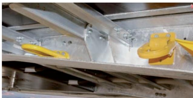
Figura 11: Simulación tirando de los anclajes para transporte marítimo
