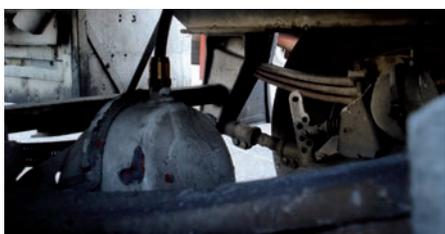
Figura 14: Tomas de presión difícilmente accesibles
