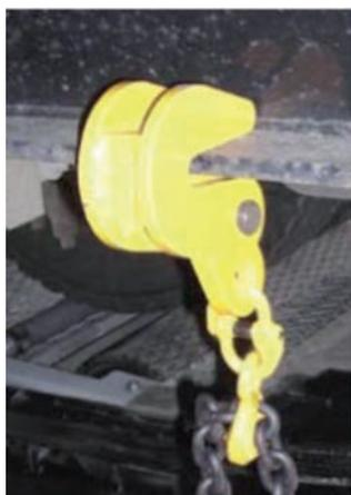
Figura 10: Simulación tirando del ala del bastidor
