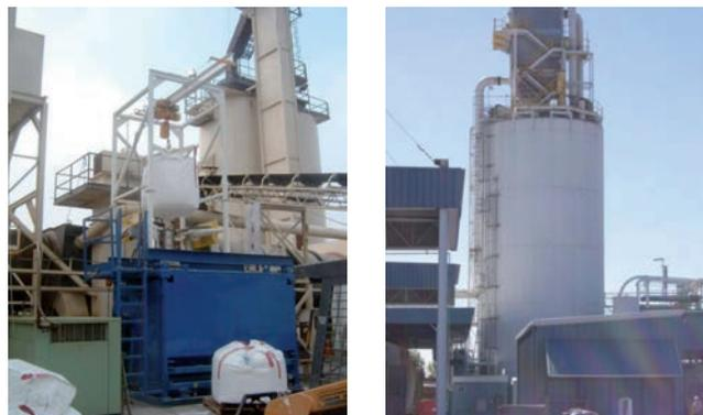
Fig. 5: Llenado del alimentador mediante maquinaria de descarga de sacos a granel, o a través de su conexión a un silo [3]
