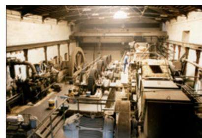
Fig. 6: Máquina de vapor y tren de molinos de la azucarera N<sup>o</sup> S<sup>a</sup> del Rosario (Salobreña).
