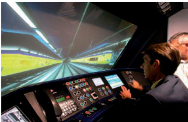
Fig. 1: Simulador vehicular: sistema de presentación y de entrada de datos<sup>6</sup>
