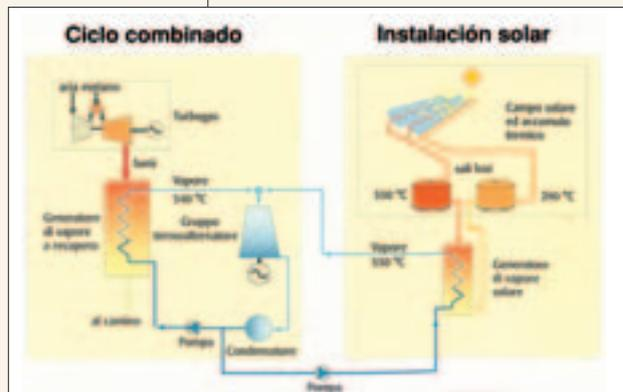
Figura 3 – Esquema de principio de la instalación.
