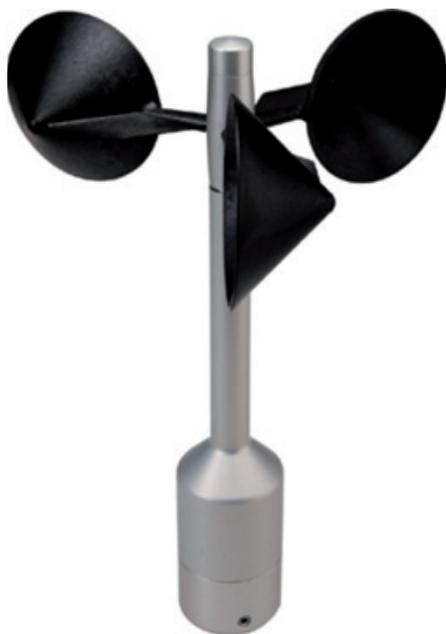
Fig. 3: Anemómetro de cazoletas Thies First Class
