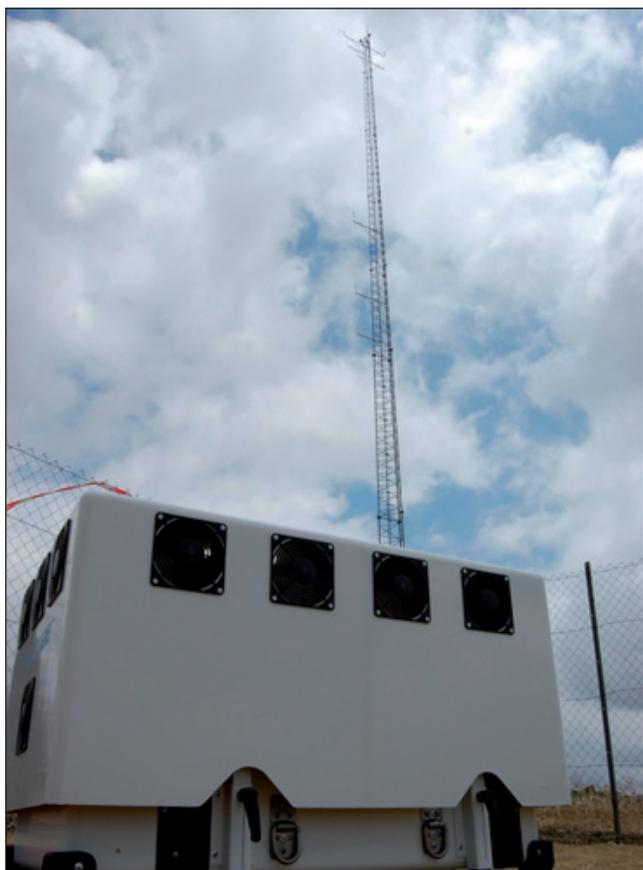
Fig. 2: Equipo LIDAR (delante) frente a torre meteorológica convencional (detrás) [4]
