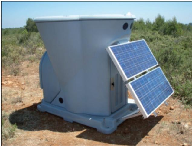
Fig. 6: SODAR Tritón. Imagen cortesía de la empresa Wind BS Technology
