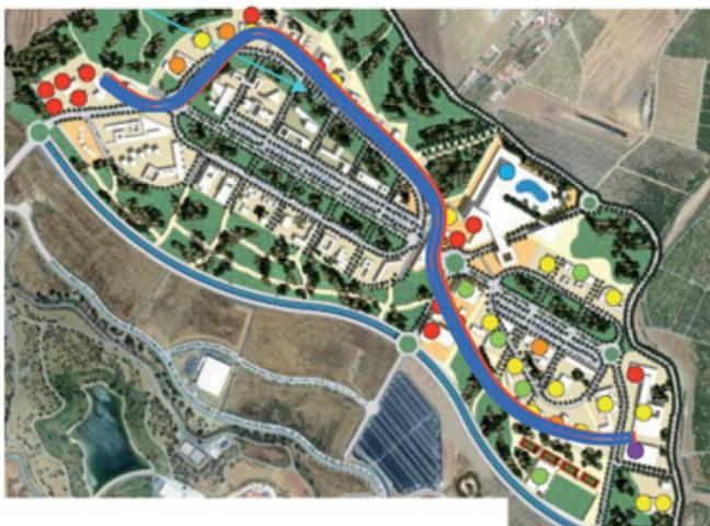
Fig. 9: Trazado de la red de distribución de calor y frío
