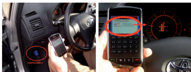
Fig. 3: Aspecto de un sistema embarcado para registro y procesado de los datos del bus CAN
