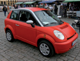
Fig. 2a Th!nk City. Batería 23 Kwh LiOn. Autonomía 160km. Potencia 34kW/ 46CV. Precio 25.000 €
