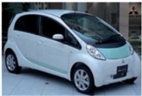
Fig. 2b Mitshubishi i-Miev. Peugeot Ion. Citroën C-Zero Batería 16 Kwh LiOn. Autonomía 121km. Potencia 47kW/ 64CV. Precio 30.000 €
