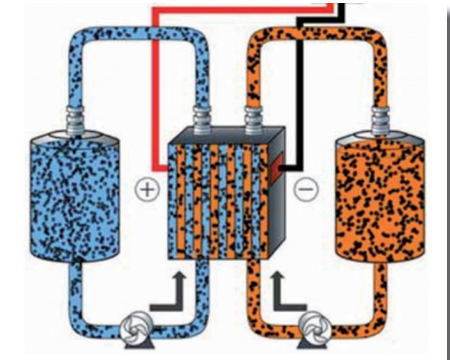
Esquema de la batería con partículas en suspensión
