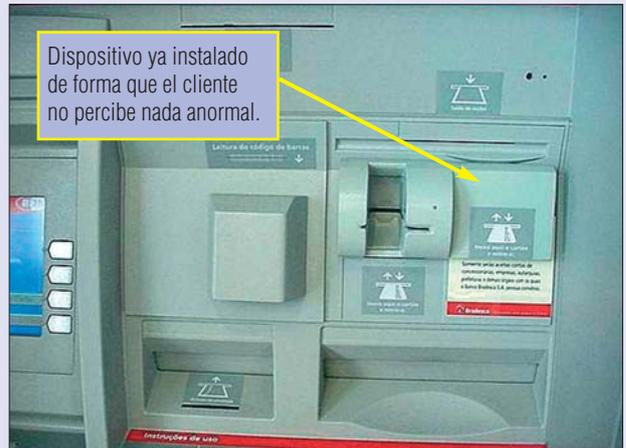
Dispositivo ya instalado de forma que el cliente no percibe nada anormal.
