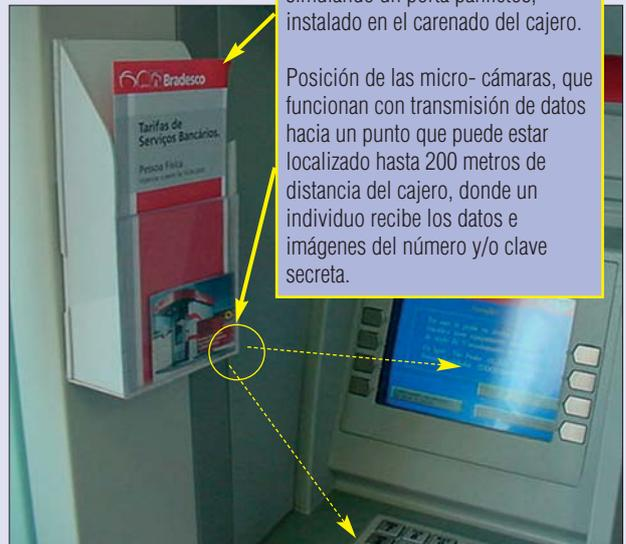
Dispositivo para la grabación simulando un porta panfletos, instalado en el carenado del cajero.
