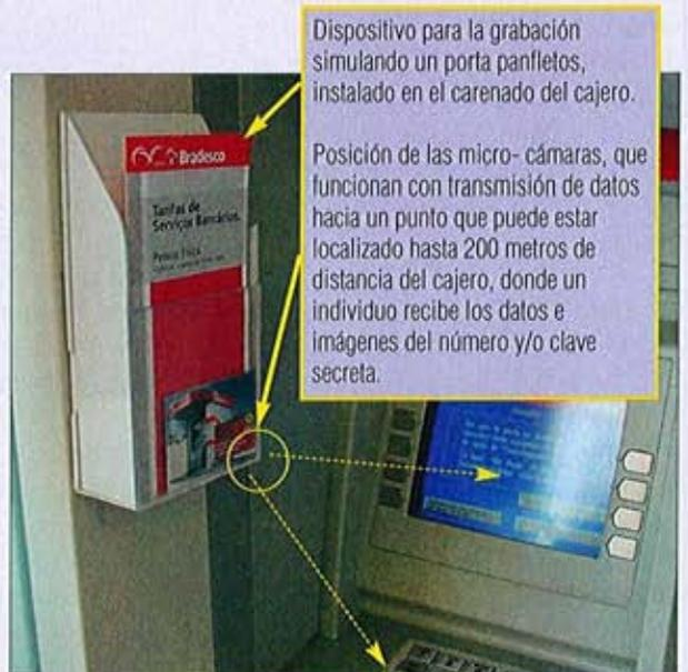
Dispositivo para la grabación simulando un porta panfletos, instalado en el carenado del cajero.
