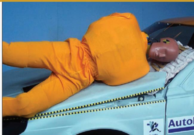
Figura 10. Ensayo del sistema de airbag para la protección de la cabeza del peatón (diseño de Autoliv).
