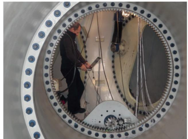
Figura 1: Rodamiento de pala: posición del rodamiento de pala en el buje de un aerogenerador y fotografía del rodamiento de pala dentro de un buje
