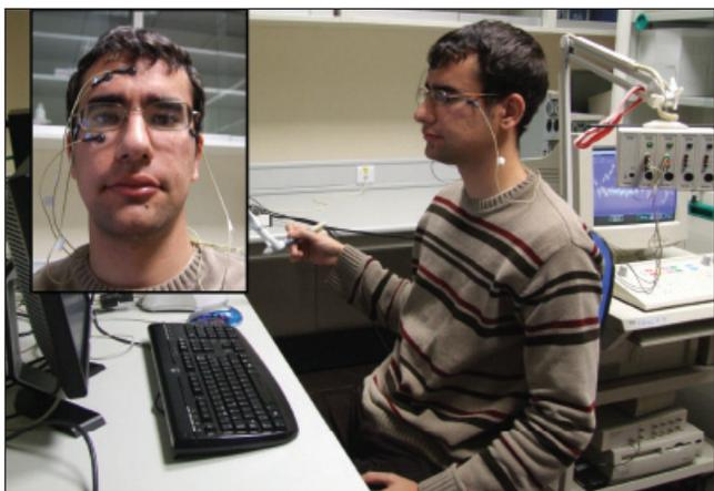
Figura 4: Sistema de adquisición EOG en el entorno local, donde aparece la persona con los electrodos puestos y el dispositivo Nicolet Viking IV D (derecha).
