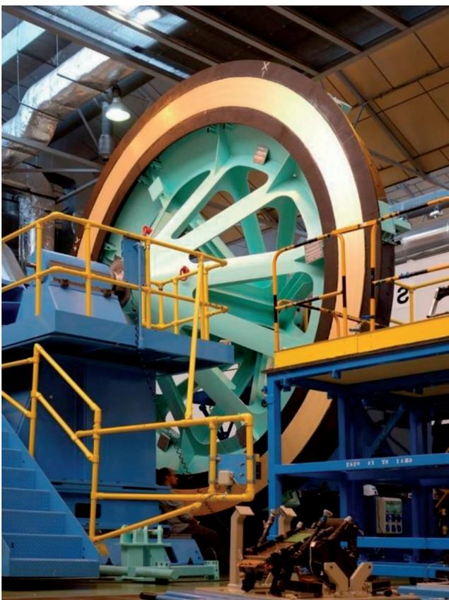
Fig. 2: Prueba de resistencia de los anillos de precompresión que sujetarán radialmente los imanes superconductores en ITER. Los anillos, de fibra de vidrio, están siendo fabricados por Airbus-España, en Torrejón de Ardoz (Madrid). (Cortesía de ITER Organization)
