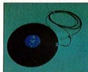
Figura 5: Acelerómetro de cuerpo completo
