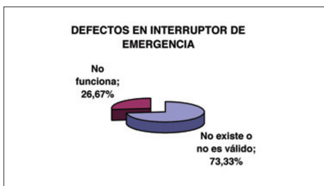
Gráfica 5 Distribución de defectos en Interruptor de Emergencia (Fuente: elaboración propia)
