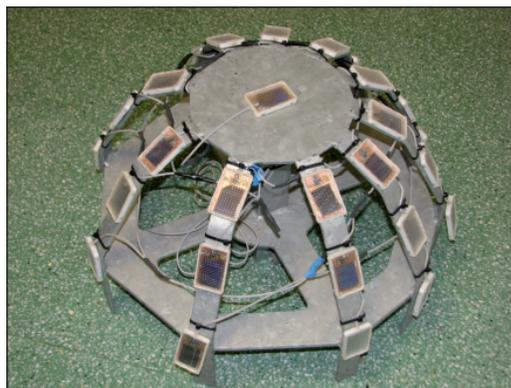
Sensor hemisférico de radiación solar
