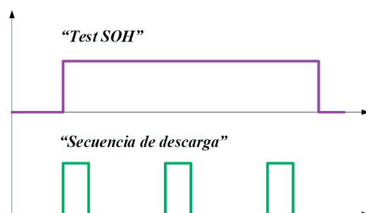
Figura 2: Señales que el cargador de baterías envía al variador del ascensor para que descargue la batería de manera pulsante
