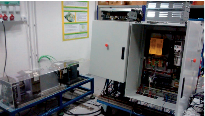
Figura 4: Banco de ensayos de laboratorio que emula un ascensor real para testeo de algoritmo de SOH
