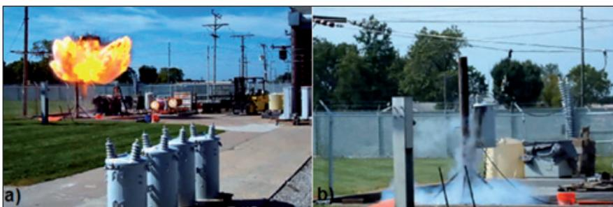
Fig. 4: Ensayos de fallos con arco de alta energía con a) Aceite mineral y b) Éster natural de girasol alto oleico
