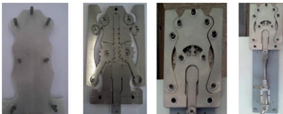
Fig. 5: Modelo de la pinza de dos dedos retráctiles en acero inoxidable
