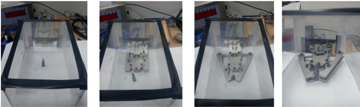
Fig. 1: Operación de agarre de un objeto en recinto un comunicado con el exterior mediante una abertura
