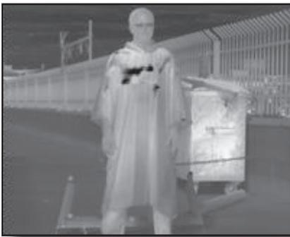
En la imagen, captada con una cámara de THz, se aprecia el revolver que una persona oculta bajo su ropa.
