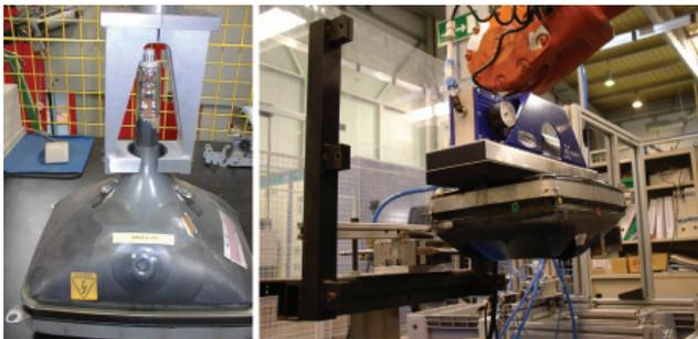
Fig. 3: Manipulación robotizada de componentes de aparatos electrónicos: garras (izda.) y ventosa de vacío (dcha.)
