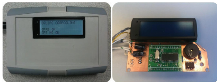
Fig. 2: Dispositivo dentro de la carcasa y circuitería interna
