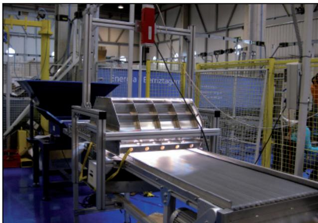
Figura 15. Instalación experimental de clasificación y separación. Al fondo se aprecia la tolva para residuos triturados que los vierte laminadamente en una cinta transportadora, el bloque de visión artificial que está compuesto por un sistema de iluminación y una cámara hiperespectral, y la cinta transportadora que lleva los residuos a la separación final.
