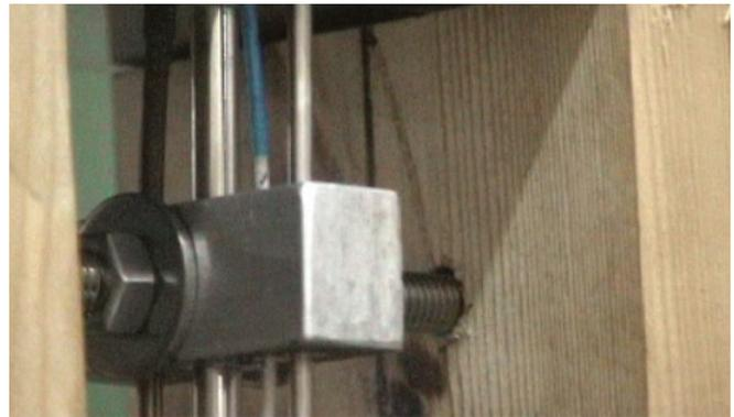
Figura 7: Termopares en contacto con metal base
