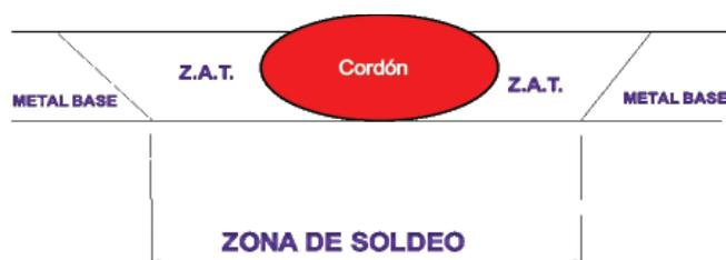
Figura 1: Zona Afectada Térmicamente (ZAT)
