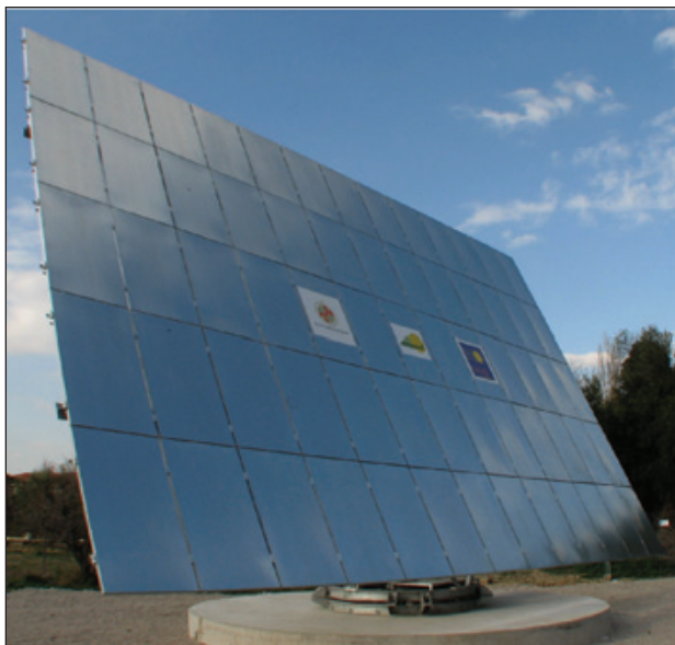
Figura 11. Prototipo del seguidor solar en su ubicación actual para pruebas (superficie 84m²)
