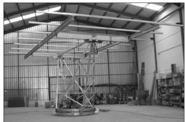
Figura 8. Vista de la estructura (peso 4000 kg). Fotografía del conjunto formado por la torre y la vela.
