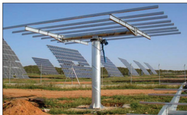
Figura 9. A) Fotografía del hidráulico empleado para el giro de la vela B) Esquema de la disposición los hidráulicos para el giro de la vela C) Gráfica en la que se ilustra la variación de la componente tangencial (responsable del giro en el plano cenital) y de la longitud de los pistones con el ángulo respecto a la horizontal durante el movimiento en el plano acimutal.
