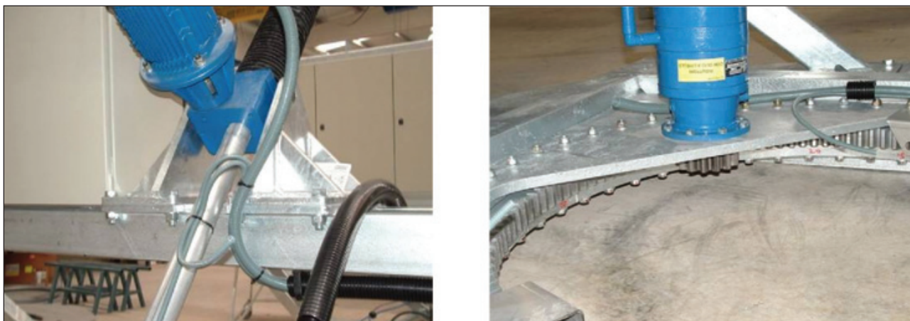
Figura 5. Detalle de un mecanismo para el movimiento de un seguidor solar A) cenital (sistema de tornillo de potencia), B) acimutal (sistema de piñón + corona).
