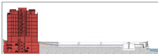
Fig -21 (Captación del agua de la ría y canalización del depósito nodriza al edificio)
