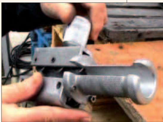
Fig. 5. Herramienta para el corte longitudinal del tubo de aluminio
