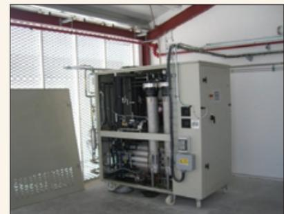
Fig.1 Electrolizador alcalino Idroenergy
