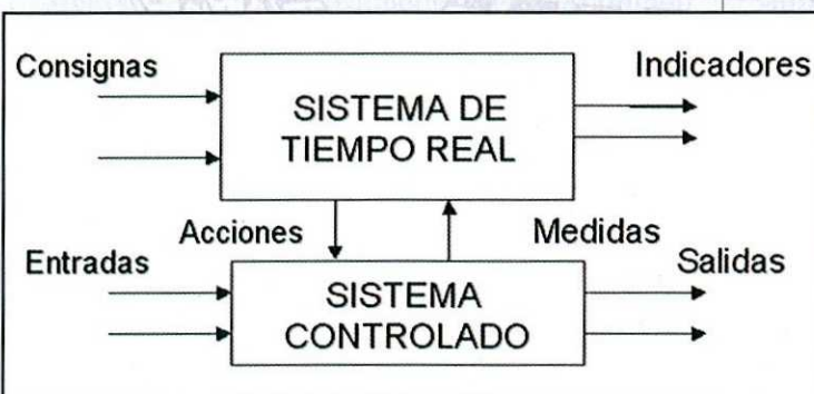
Figura 1. Esquema básico de un sistema de tiempo real.
