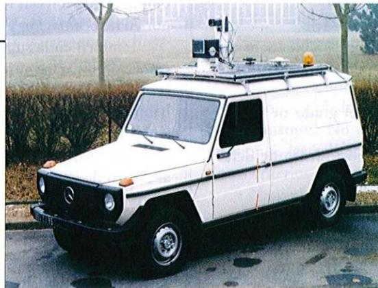
Vehículo guiado mediante un sistema de visión.
