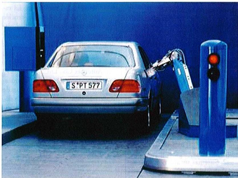
tar dotado de un identificador electrónico que es leído por el robot. La posición exacta del coche se detecta mediante cámaras mientras que el espacio de trabajo del robot es vigilado mediante *scanners* de láser.
