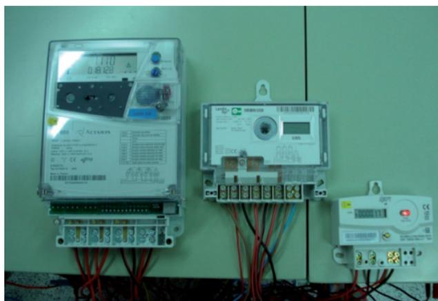
Fig. 2: Contadores sometidos a ensayo
