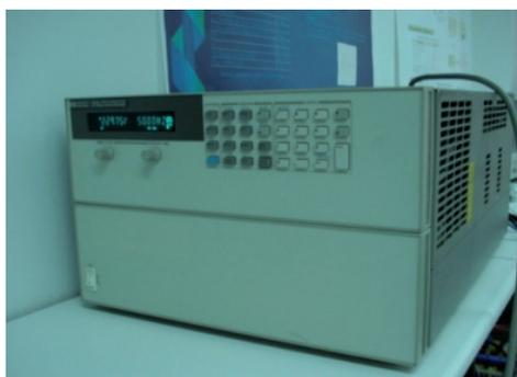
Fig. 3: Fuente de perturbaciones programable como sistema generador.
