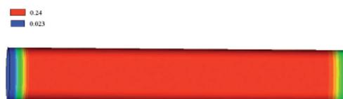
Fig. 8: Coeficiente de Tsai-Wu en una botella en aluminio y fibra de basalto a 0° y 90° en la fibra a 90° en la virola
