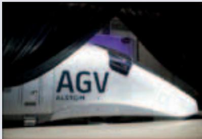
nuevo tren de alta velocidad de nueva generación, La Automotriz Gran Velocidad (AGV), que combina la arquitectura de los trenes articulados con *boggy* compartido con la motorización distribuida.
