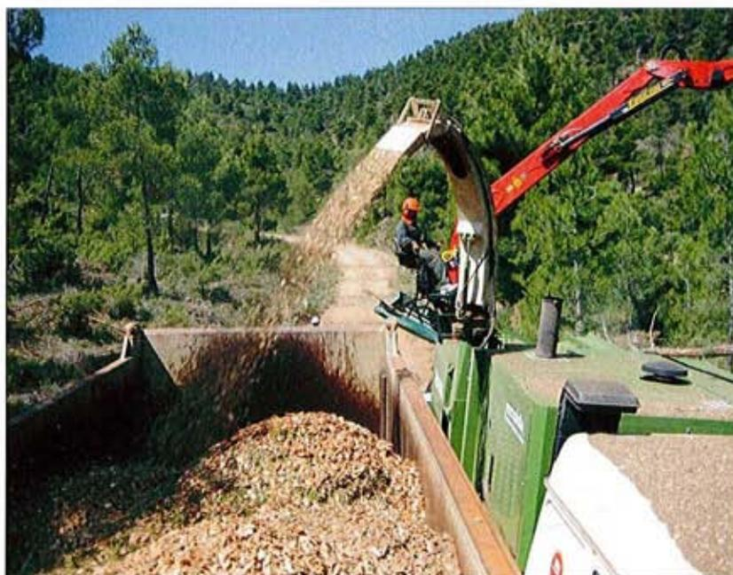
Figura 3. Llenado de camiones con la astilla generada.
