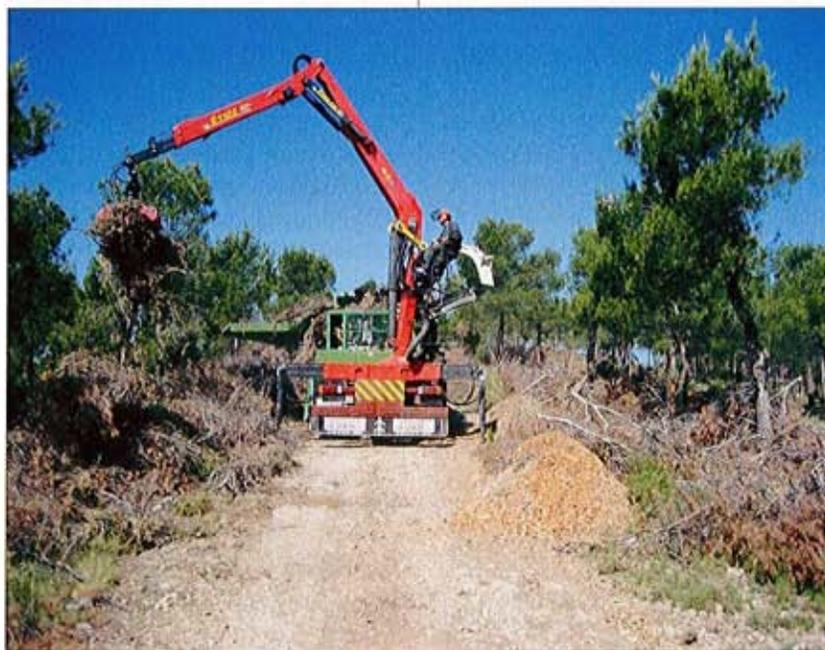
Figura 2. Alimentación de la máquina astilladora con los restos de podas.
