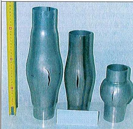
Ensayos de hidroformado
