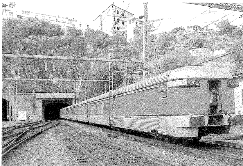
La nueva cabeza motriz evitará este proceder: un Talgo procedente de Francia tiene que entrar en Portbou empujado lentamente, con un hombre que va indicando por teléfono al maquinista cómo están las señales o si hay que ferner por algún imprevisto
