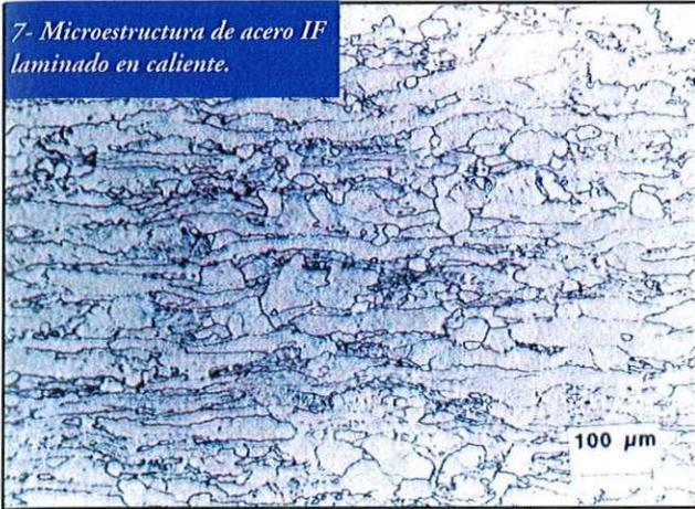
La que sigue es una composición típica de acero IF *ultra low carbon*. En partes por millón en peso: 10 ppm C, 15 ppm N, 100 ppm Ti (0.010%Ti), 100 ppm P- refosforado-, 100 ppm Mn, 5 ppm S. Las características mecánicas de este acero resultaron ser: Re igual a 120 MPa, alargamiento superior al 50% (para Lo igual a 50 mm), coeficiente "n" superior a 0,25, coeficiente "r" de Lankford a igual a 2,5 en la dirección de laminación.
