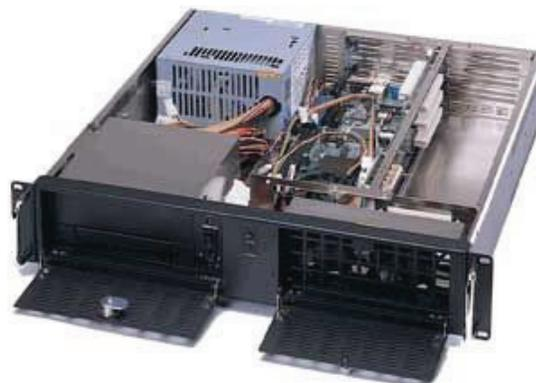
Fig. 5: Ordenador industrial utilizado para el control de la cámara hiperbárica
