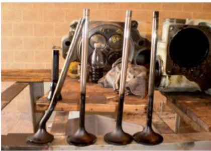
Fig. 1: Válvulas de escape quemadas
