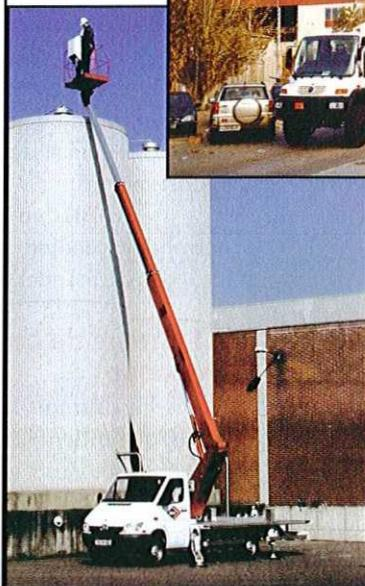
Aisladas a 46 kV para trabajos en tensión
