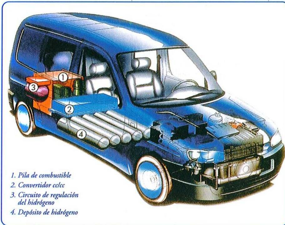
Programa Hydro-Gen (PSA Peugeot/Citroën). Integración de una pila de combustible.
