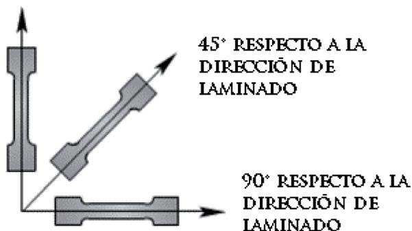
Fig. 12. Direcciones consideradas para los coeficientes de Lankford [9]
