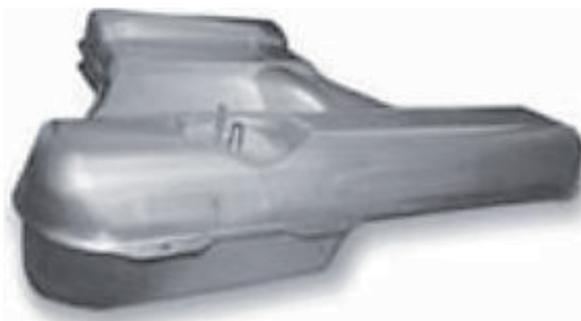
Fig. 2: Pieza generada por hidroconformado [3]
