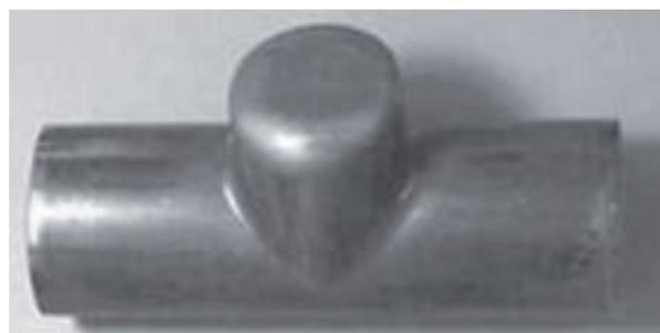
Fig. 3: Generación de tuberías en T por hidroconformado [3]
