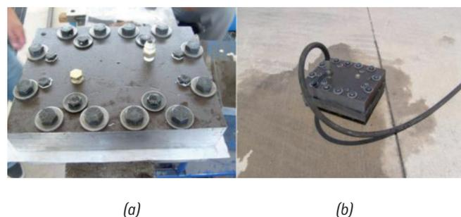
Fig. 20: Desarrollo de las pruebas experimentales. (a) Troqueles ensamblados (b) Proceso de hidroconformado
